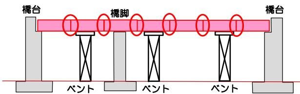
桁と桁をボルトで固定します。
