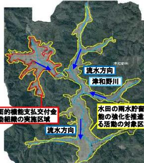
・津和野町では、津和野川への流出抑制、高津川流域への流出抑制による被害軽減を目的に、多面的機能支払交付金活動組織へ田んぼダムに係る啓発活動や研修を実施し、水田貯留機能の強化の推進している。
