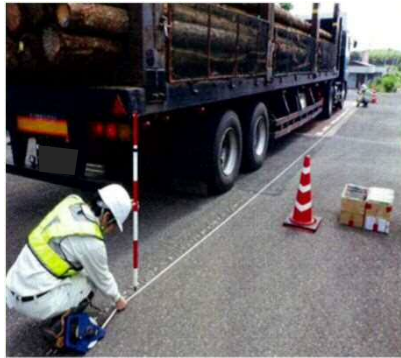
車両寸法計測(長さ)
