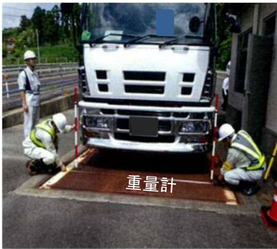
車両重量計測・寸法計測(幅)
