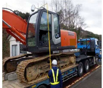
車両寸法計測(高さ)
