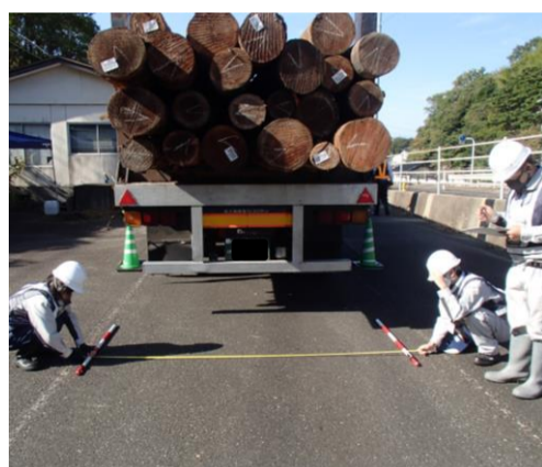
車両重量計測・寸法計測(幅)
