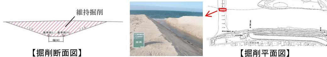
図 6.17 河口砂州の維持掘削事例（H28 年度）
