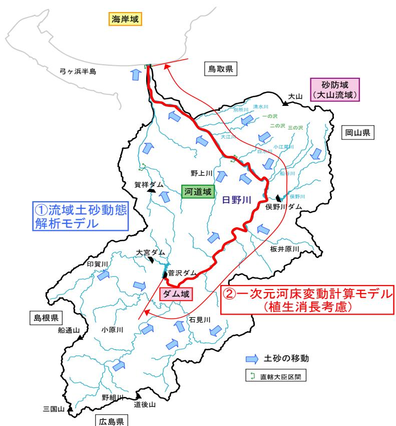
図 1 日野川流域の土砂移動予測モデル
