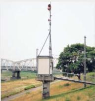
日野川水系(9箇所)に設置された水位観測所水位を常に観測しています。また、事務所においてデータの蓄積、流量への換算を行っています。
