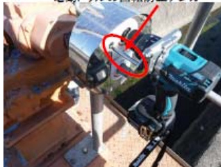
電動ドリルの回転防止アンカー
