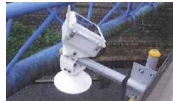
低コスト型水位計の設置例
