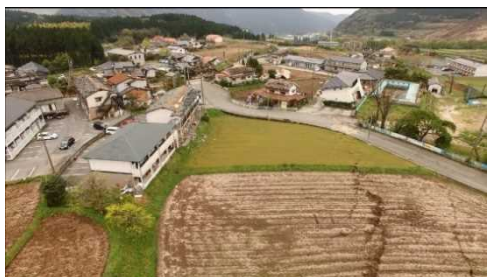
ドローンによる断層調査(南阿蘇村)
