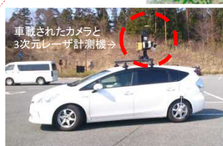
MMS(車両搭載型計測器)
