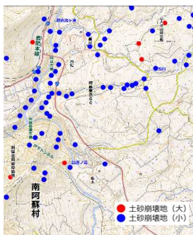
航空写真により土砂崩壊地の分布 を判読し地図化
