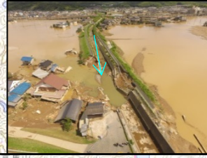
【堤防の決壊】(県) 左岸L=20m(高馬川左岸0k付近) 右岸L=100m(高馬川右岸0k100付近)
