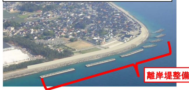
離岸堤の整備による高潮対策事例
