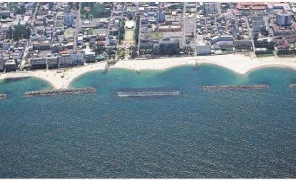
●写真中央の構造物がクレスト型人工リーフ
