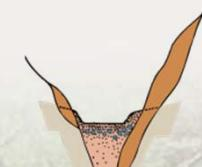
土砂流発生時に、砂防堰堤に土砂が貯まることで法面を抑え山崩れを防止します。
