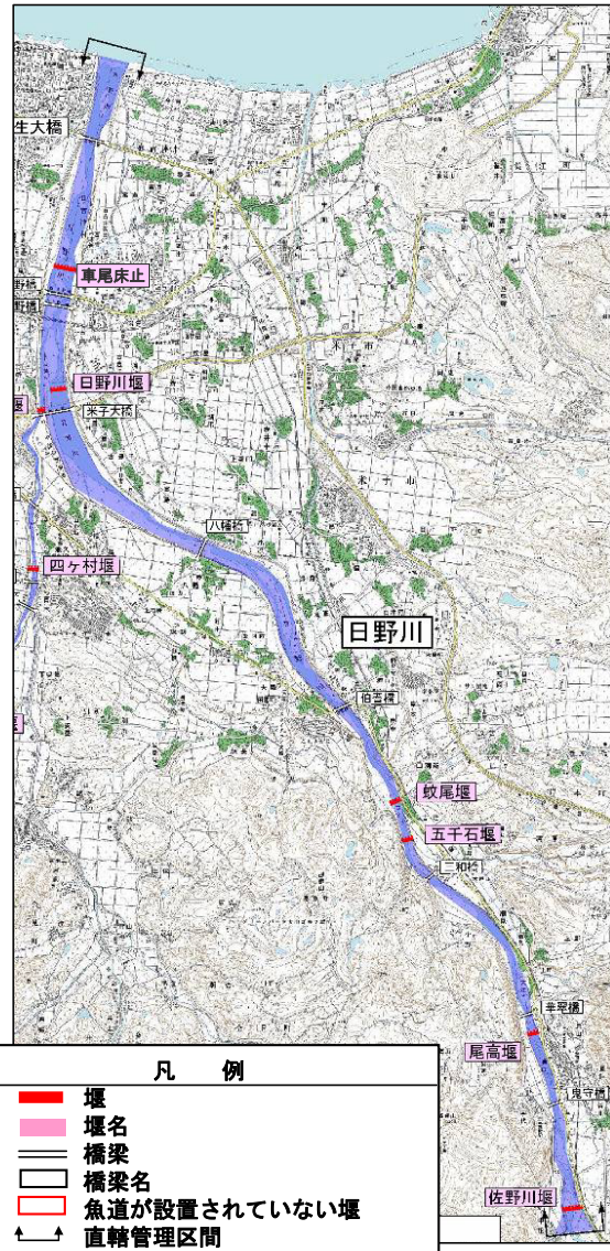
日野川の横断構造物と魚道の設置状況
