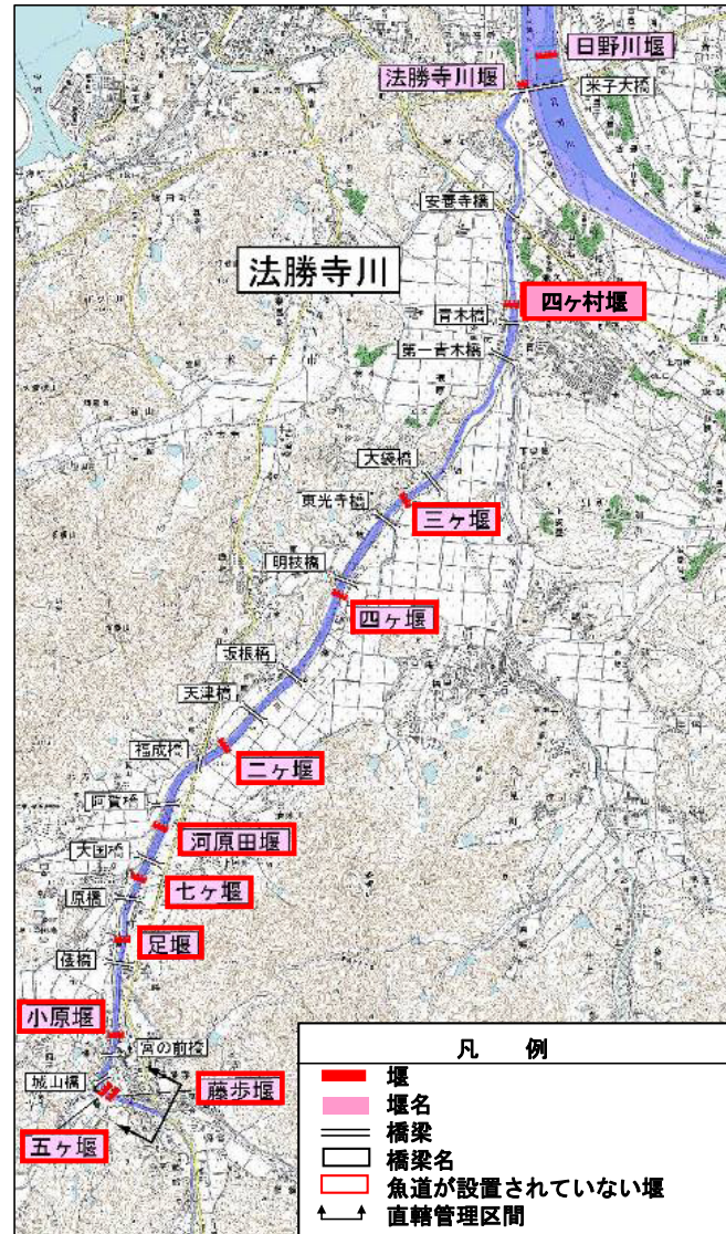
法勝寺川の横断構造物と魚道の設置状況
