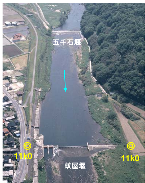
戦後最大流量に対する流下能力不足区間に位置する固定堰
