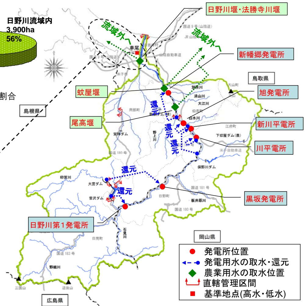
日野川筋の主な発電所位置と発電用水の導水・還元状況ならびに直轄管理区間において流域外へ導水される農業用水の取水位置
