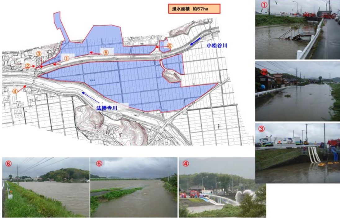
8 9 図 2.1.8 平成 23 年 9 月台風 12 号での内水氾濫による浸水図
