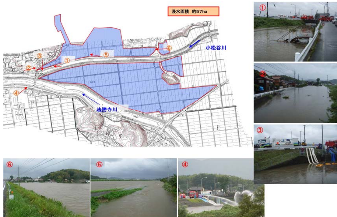
図 2.1.8 平成 23 年 9 月台風 12 号での内水氾濫による浸水図
