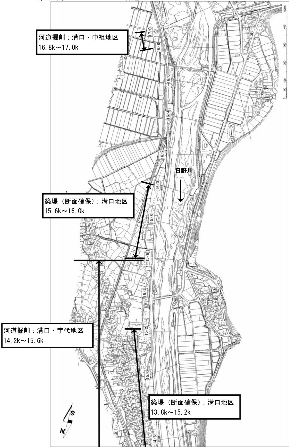
※本図は平成26年度末時点での河川の状況をもとに、概ねの施工範囲等を示すものであり、詳細な施工範囲等については、測量設計等を行い決定します。
