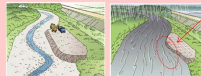
置いた土砂が洪水時に流下
