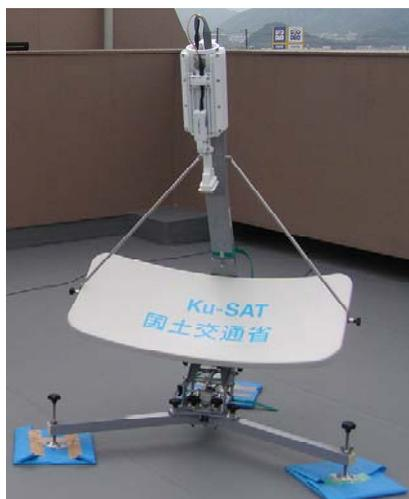
写真 衛星小型画像伝送装置
