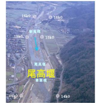
日野川中流区間の堰改築・継ぎ足しの位置図
