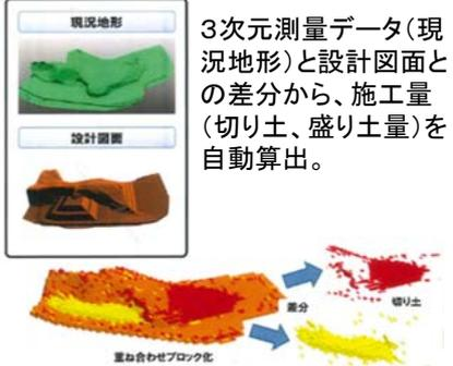
3次元測量データ(現況地形)と設計図面との差分から、施工量(切り土、盛り土量)を自動算出。
