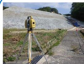
切土盛土施工完了後、短時間で出来形計測可能。測量補助員の立入が不要になり早期に次工程への展開が可能。
