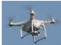
UAV(ドローン等)による3次元測量
