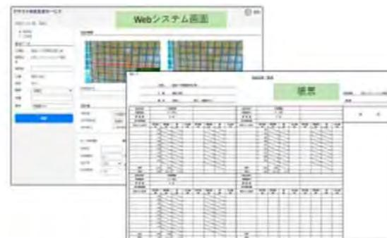
タブレットでの鉄筋計測結果とその画像はクラウド環境に保存されます。Webシステムで計測結果の確認、帳票の自動生成が可能です。
