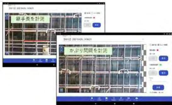
画像から三次元の距離を計測する仕組みを活用し、鉄筋の継手長、かぶり間隔を自動計測します。
