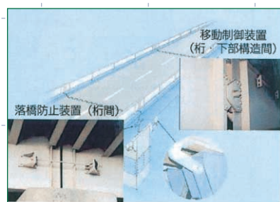
◀ 落橋防止装置 桁間に落橋防止装置、下部構造間に移動制御装置を設置することで補強します。
