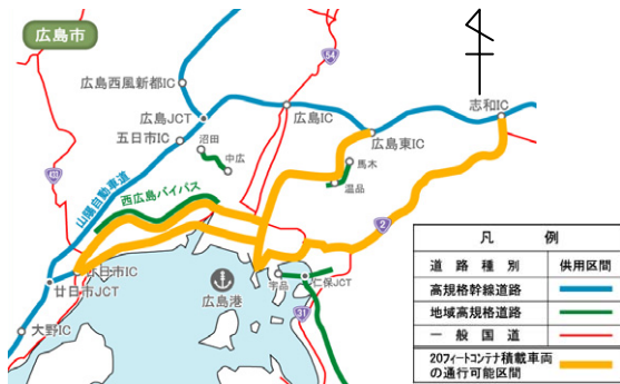
注3) 高規格幹線道路及び広島高速道路は、20フィートコンテナ通行可能。 図3-3 広島港から高速ICまでの20フィートコンテナ通行可能路線
