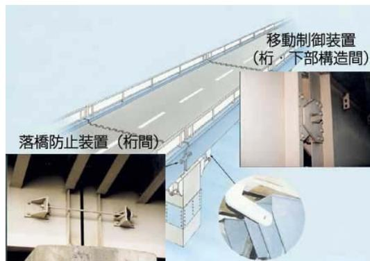
桁間に落橋防止装置、下部構造間に移動制御装置を設置することで補強します。
