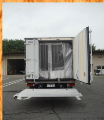
冷気を逃がさない工夫(ビニールカーテン)
