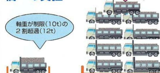
仮に、大型車両1台が、軸重10トンの基準よりも2トン超過した場合は、舗装に対しては約2台分、RC床版に対しては約9台分の疲労が蓄積されることとなります。
