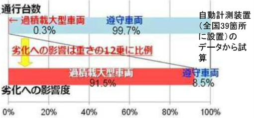
⇒ 軸重20トン車が道路橋に与える影響は、軸重10トン車の約4,000台に相当
