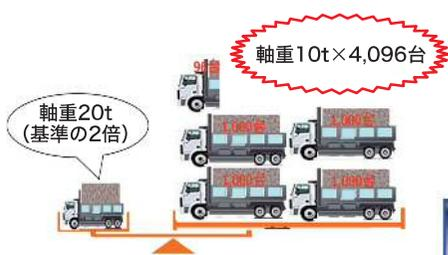
軸重が20トンの車両は、橋(RC床版)に対して軸重10トンの車両約4,000台分の疲労を蓄積させることになります。
