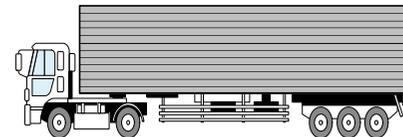
※ 車両制限令第3条第2項に定める「**特例5車種**」以外の車両に係る**一般的制限値(基準)**は、**最大25t**(国管理道路の場合)
