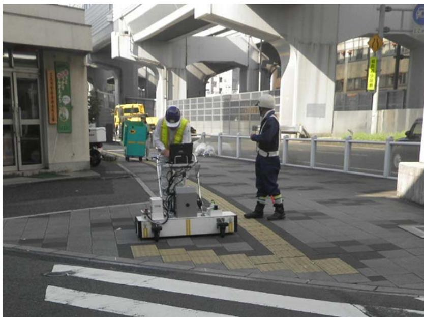
歩道下空洞探査装置
