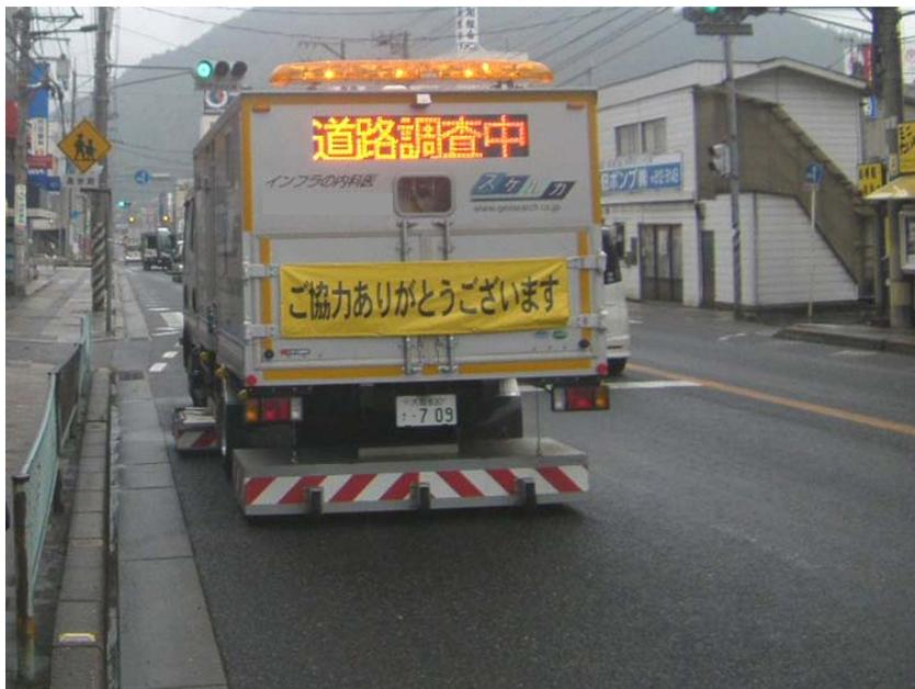
路面下空洞探査車
