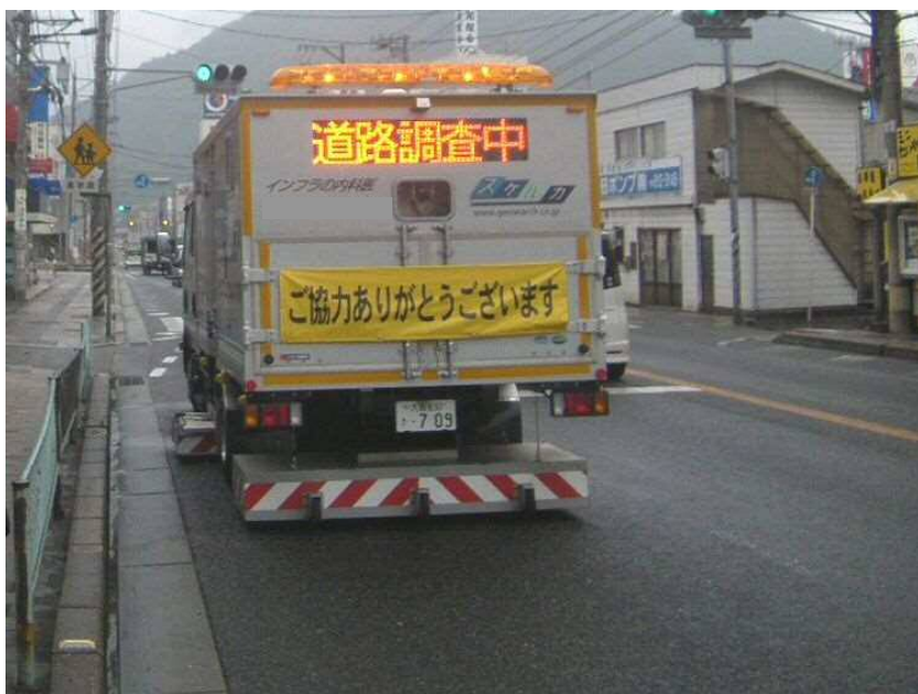
路面下空洞調査車 (三次元多配列レーダー)
