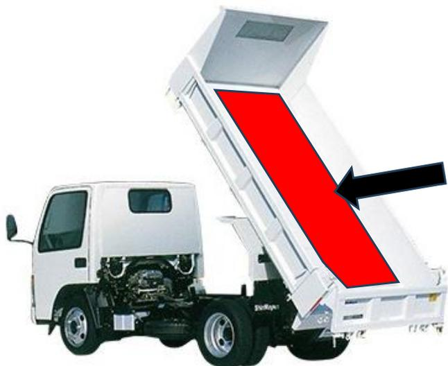
ダンプトラック荷台に緩衝材を設置し、コンクリートがら等を積み込む時に発生する、騒音を低減します。
