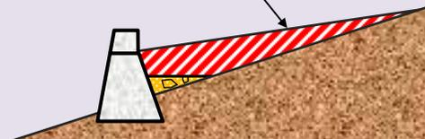
大規模出水時には、土砂が貯まり、下流への土砂流出を軽減します。
