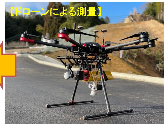
工事着手前にドローンで地形の測量を実施します。
