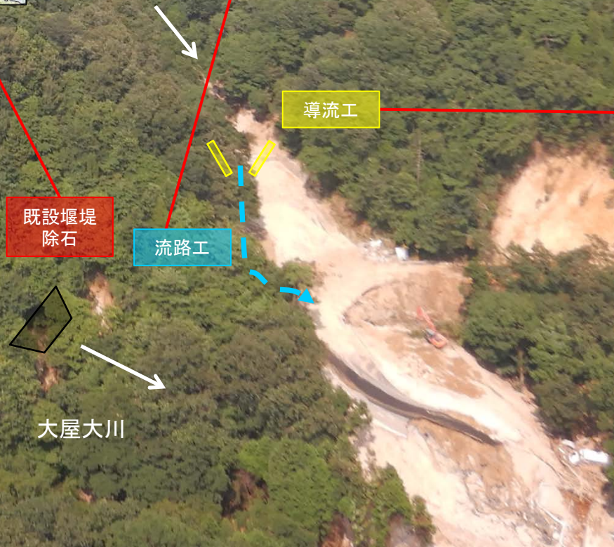
流路工(断面確保)実施状況
