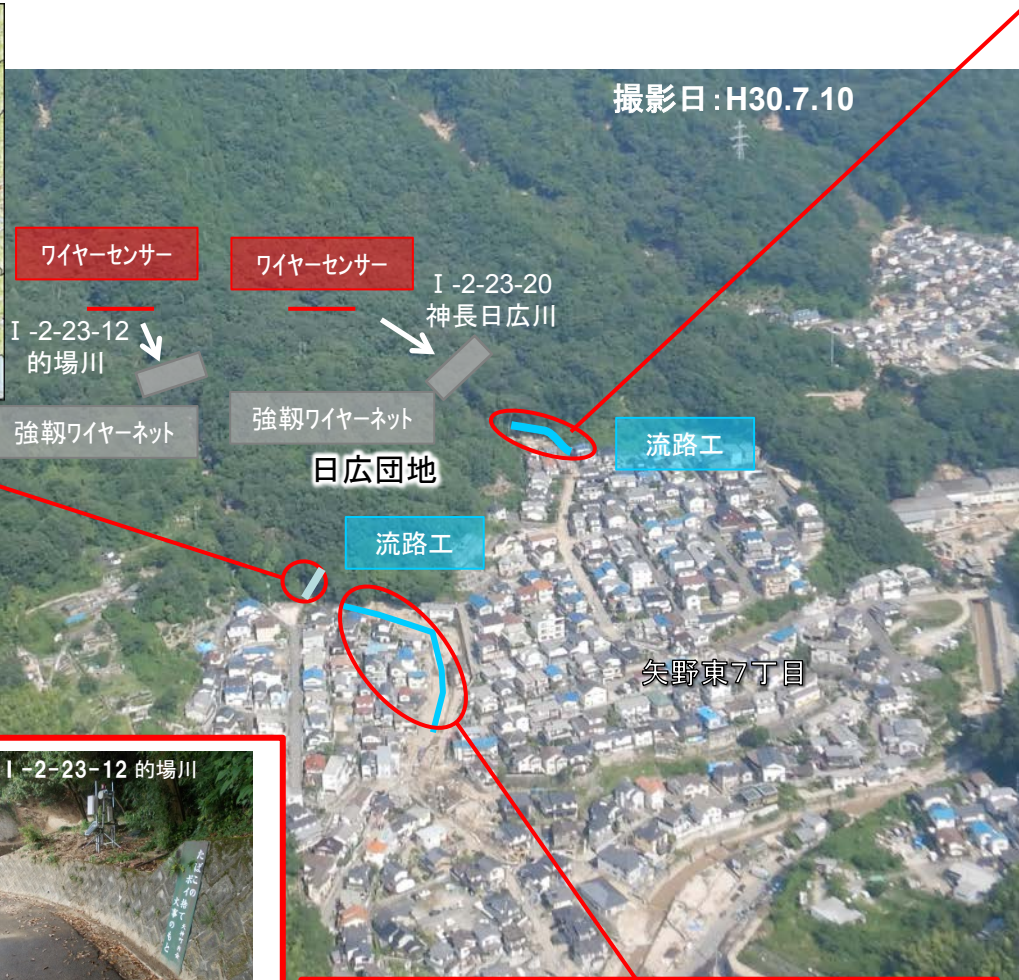
流路工(断面確保)実施状況
