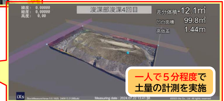
スマホによる浚渫土運搬量の計測
