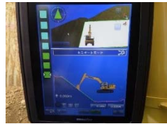
3次元MCバックホウによる施工
