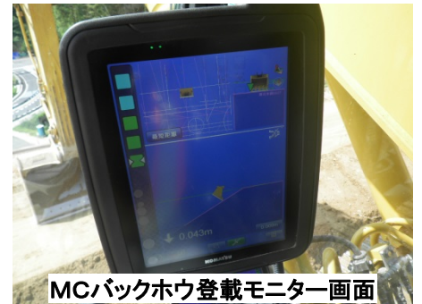
MCバックホウによる切土法面整形
