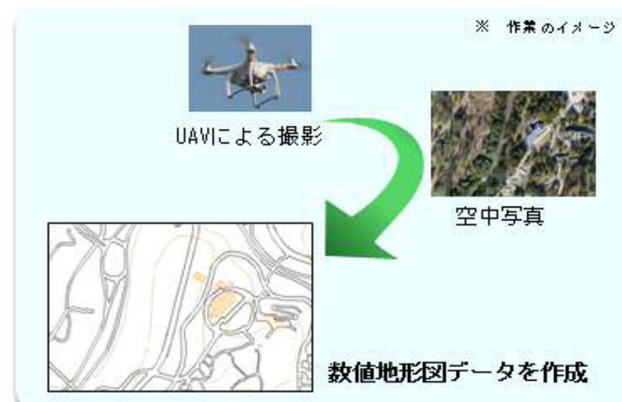
UAVを用いた空中写真測量
