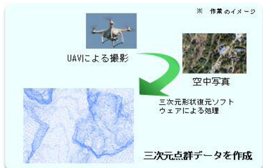
UAVを用いた空中写真による三次元点群測量
