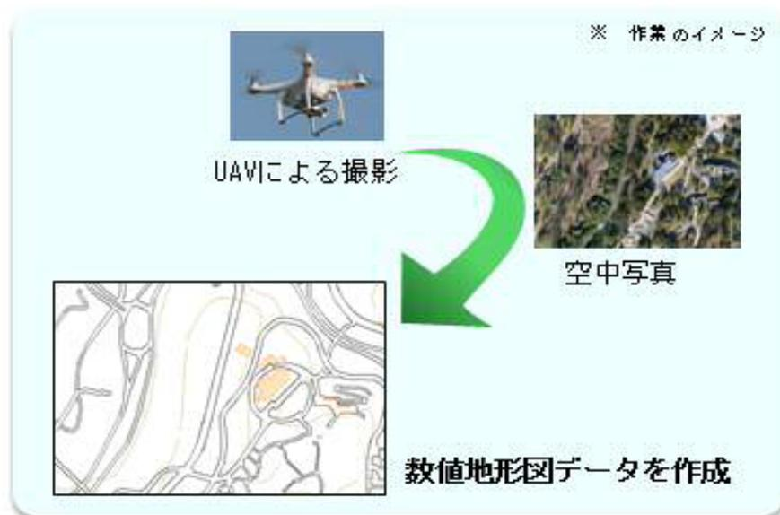
UAVを用いた空中写真測量
