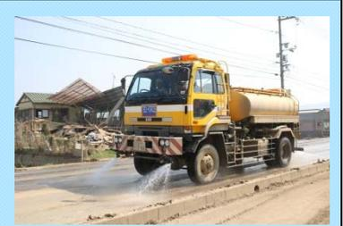
「散水車」による道路啓開作業補助
