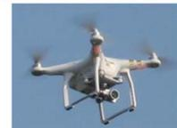
UAV(ドローン等)による3次元測量
