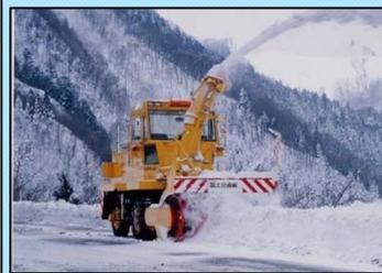
「ロータリー除雪車」による除雪作業
