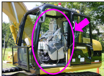
無人化施工機械[九州]
