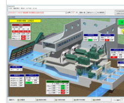
排水機場監視画面
