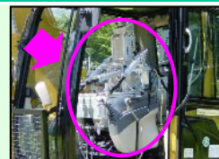
民間のバックホウ取付タイプの 遠隔操縦用機器です。(最大150mの遠隔操縦可能)
