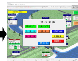
排水機場操作画面（装置選択画面）
