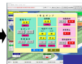
排水機場操作画面（運転操作画面）
