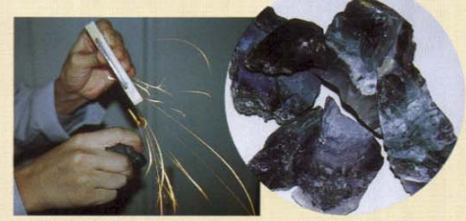
開削部硬岩から火花が出た瞬間です!! 開削部で採取された硬岩
