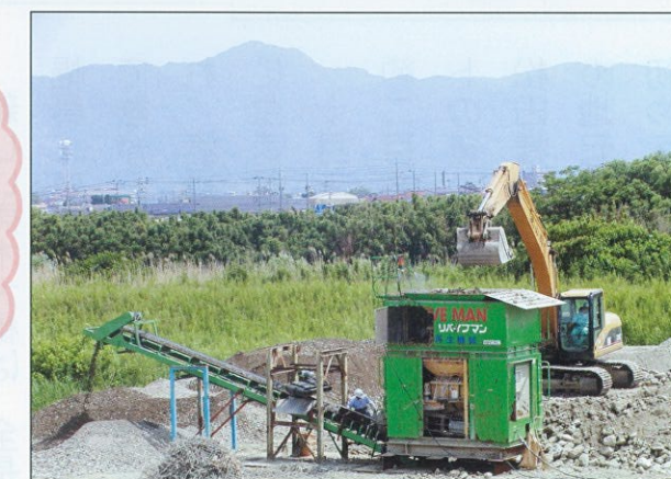
取り壊したコンクリートは骨材再生機により碎石に再生し、有効利用しています。
