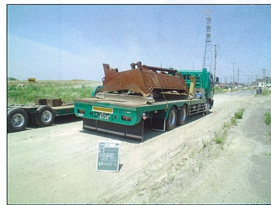
ブレード(排土板)の輸送
