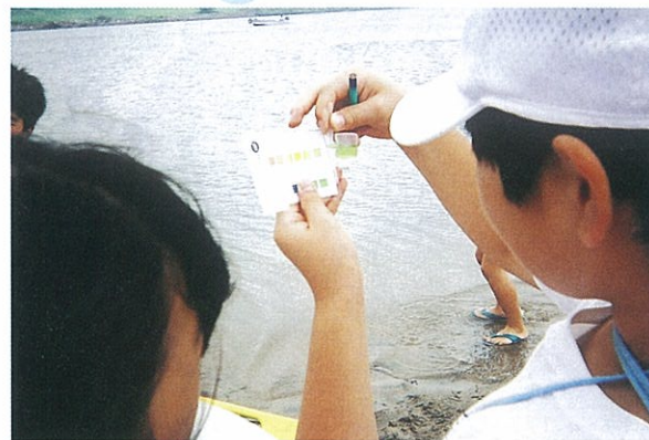
川や海の流れの緩やかな場所で水を採取し、水の※pH（ピーハー）や※CODを計ります。 ※pHは水が酸性かアルカリ性が測定するものです。 ※CODは0～8の数値で判断し、数値が高いほど汚れていることになります。
