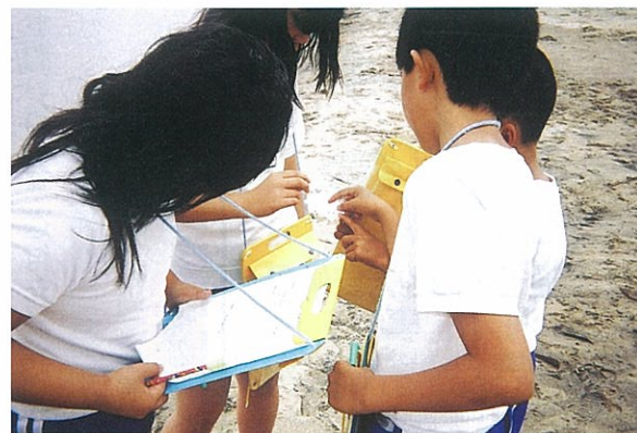
川や海の流れの緩やかな場所で水を採取し、水の※pH（ピーハー）や※CODを計ります。 ※pHは水が酸性かアルカリ性が測定するものです。 ※CODは0～8の数値で判断し、数値が高いほど汚れていることになります。
