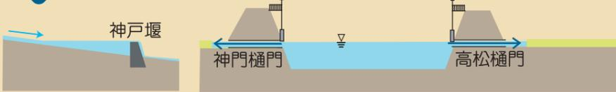
**その2 治水** 河川堤防を横断して設けられる樋門は、洪水で水位が上がった場合に、ゲートを開けて市街地の安全を確保します。基本的に各樋門の管理者により樋門の操作は行われます。
