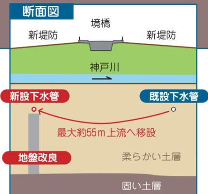
現在、国道431号境橋付近で神戸川の下を横断する下水道の移設工事が行われています。本号では、下水道の移設工事と、あわせて行われる地盤改良工事について紹介します。工事の間中はお迷惑をおかけしますが、ご協力のほどよろしくお願いします。
