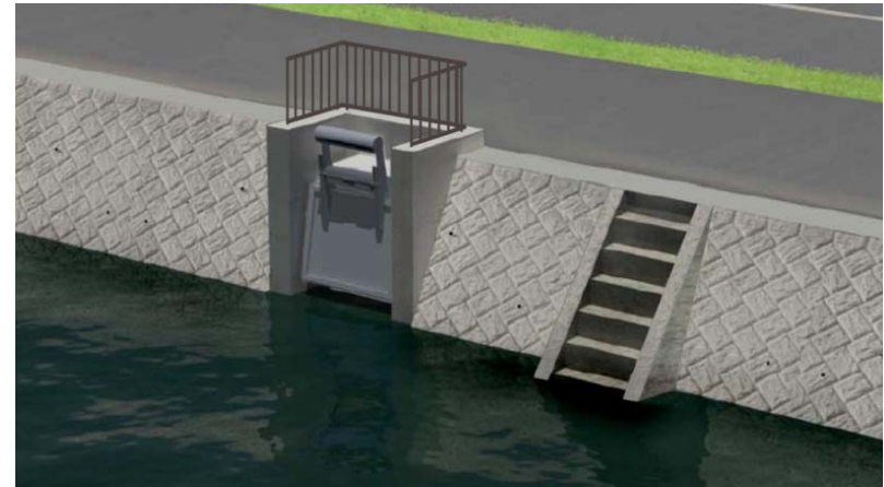
樋門施設等の管理用階段工
