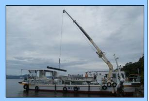
枯れ枝や小さな投棄ゴミ(例えば空き缶やペットボトル)は人力で回収し、おろち丸に積み込みます。 大きなゴミは、備え付けのクレーンで積み込みを行います。
