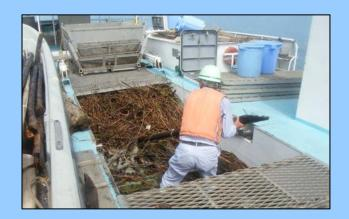
おろち丸胴体の真ん中にコンテナをセットし、航行しながら浮遊しているゴミを回収していきます。
