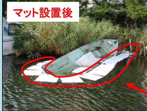
沈没した船からは油が流出していたため、油を吸着するマットで沈船の周りを取り囲み、油が広がらないよう応急処置をしました。
