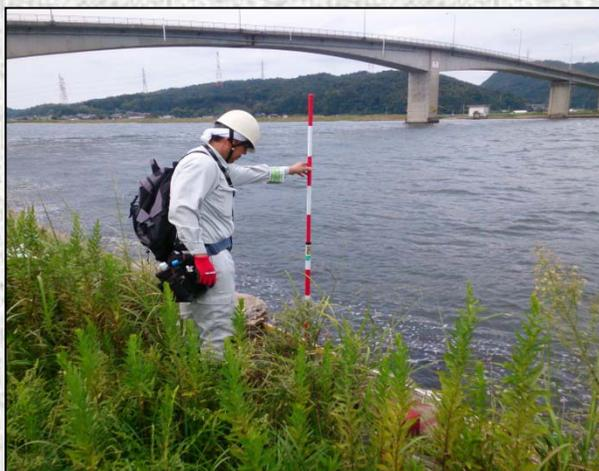
●堤防護岸の背面土砂吸い出し確認状況
