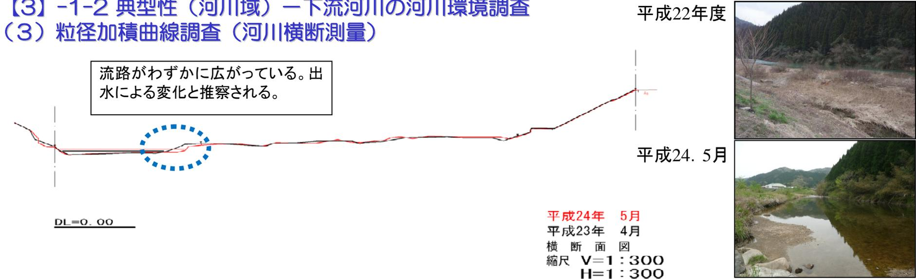
図 河川横断測量結果（St.D 阿井川合流点下流）
