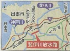
完成した斐伊川放水路。洪水時には最大で毎秒2千トンを斐伊川から神戸川に流す。出雲市上塩治町
