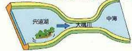
洪水を安全に流すため、中海・宍道湖の湖岸や大橋川に堤防を築きます。
